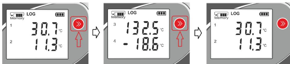
Dolní tlačítko slouží k přepínání mezi aktuálními hodnotami a Min/Max hodnotami:
