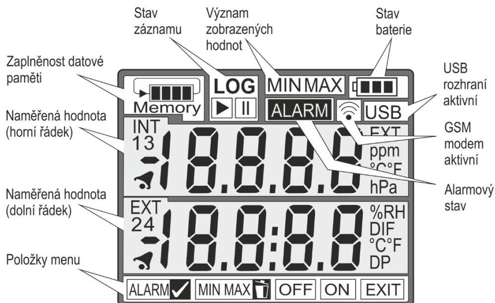
**Zaplněnost datové paměti** – poskytuje informaci o aktuálním stavu volného místa v datové paměti. Pokud nápis *Memory* bliká, znamená to, že byl překročen nastavený limit zaplněnosti paměti. Tento limit se nastavuje v konfiguraci přístroje a lze mu přiřadit různé akce (optická a akustická signalizace, odeslání SMS zpráv).
