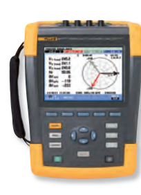
Třífázové analyzátoři kvality elektrické energie a spotřeby energie Fluke 430 řady II
